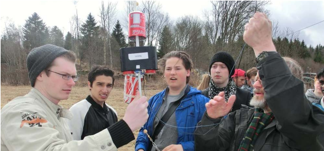
Figur 8.10 CanSat'en er montert til slippmekanismen. En Cola-boks beskytter termineringsenheten.
