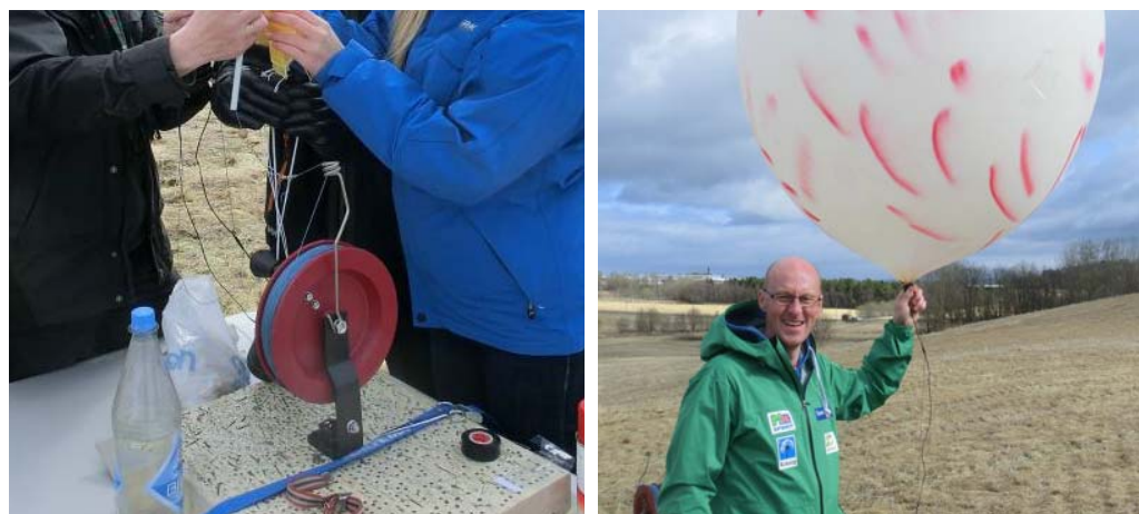
Figur 8.11 Ballongen ble forankret i en nylonsnor spunnet opp på et fiskehjul (Hitra). Ballongen ble merket med rød oljebasert spraymaling.
