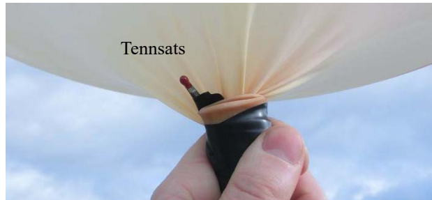
Figur 8.9 Tennsatsen tapes inntil ballongen.
